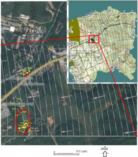
รูปที่ 20 การจำลองสถานการณ์ที่มีการสูบน้ำบาดาลปกติในฤดูแล้งและพื้นที่ที่ได้รับผลกระทบ (กรณีสีแดง)
