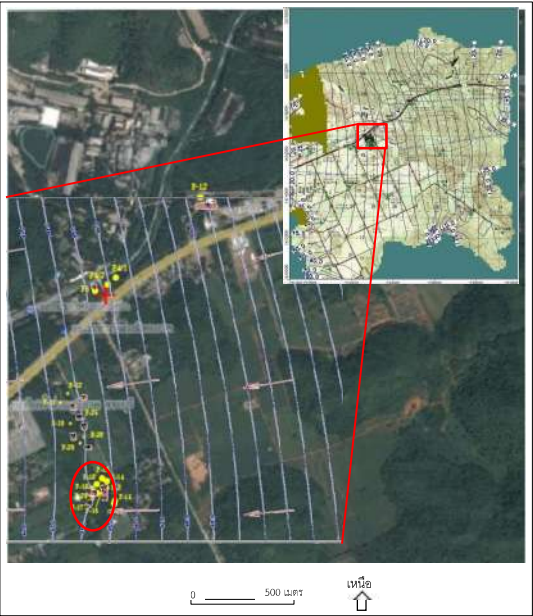
รูปที่ 21 การจำลองสถานการณ์ที่มีการสูบน้ำบาดาลปกติในฤดูฝนและพื้นที่ที่ได้รับผลกระทบ (กรณีสีแดง)
