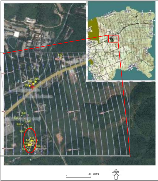
รูปที่ 22 การจำลองสถานการณ์ที่มีการสูบน้ำบาดาลทุกบ่อในฤดูฝนและพื้นที่ที่ได้รับผลกระทบ (วงรีสีแดง)
