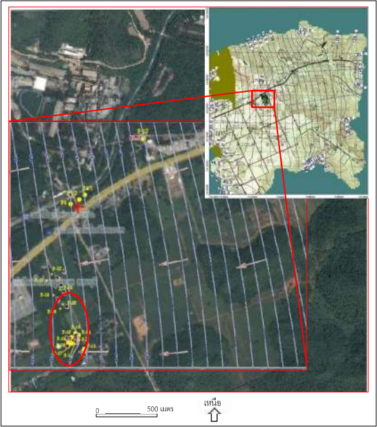
รูปที่ 22 การจำลองสถานการณ์ที่มีการสูบน้ำบาดาลทุกบ่อในฤดูฝนและพื้นที่ที่ได้รับผลกระทบ (วงรีสีแดง)
